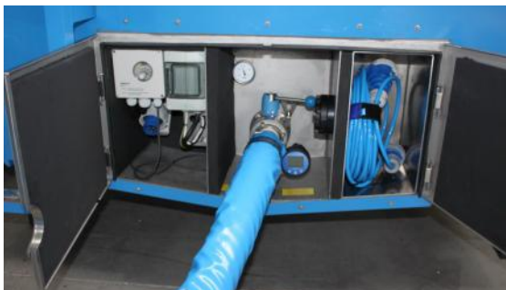
Bild unten: KTS mit angeschlossenem Trinkwassertransportbehälter AS 60 (Containerwechselsystem)
